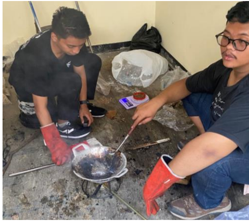
Gambar 5 proses pencampuran serat alam dan plastik PET
