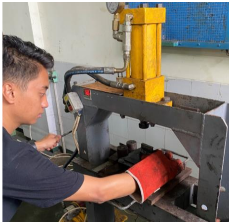
Gambar 6 proses pengepresan ecobrik
