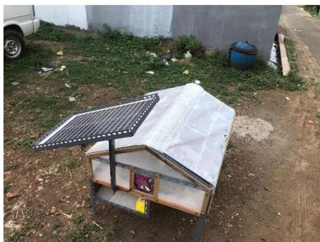
Gambar 4.1 Posisi peletakan solar drayer terhadap matahari
