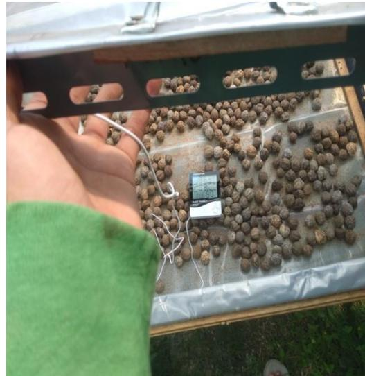
Pengujian kadar air sesudah (dalam basis kering)
