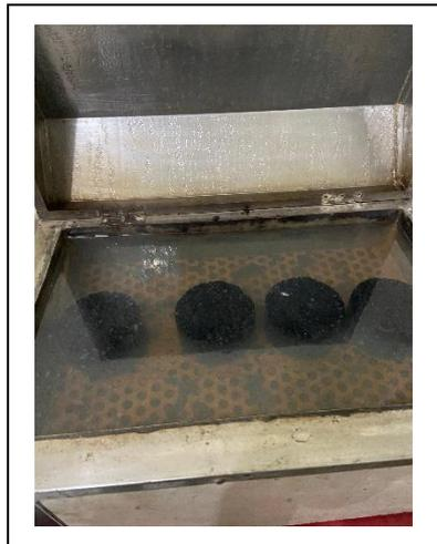
**Gambar 4.37** Sampel di dalam waterbath.
