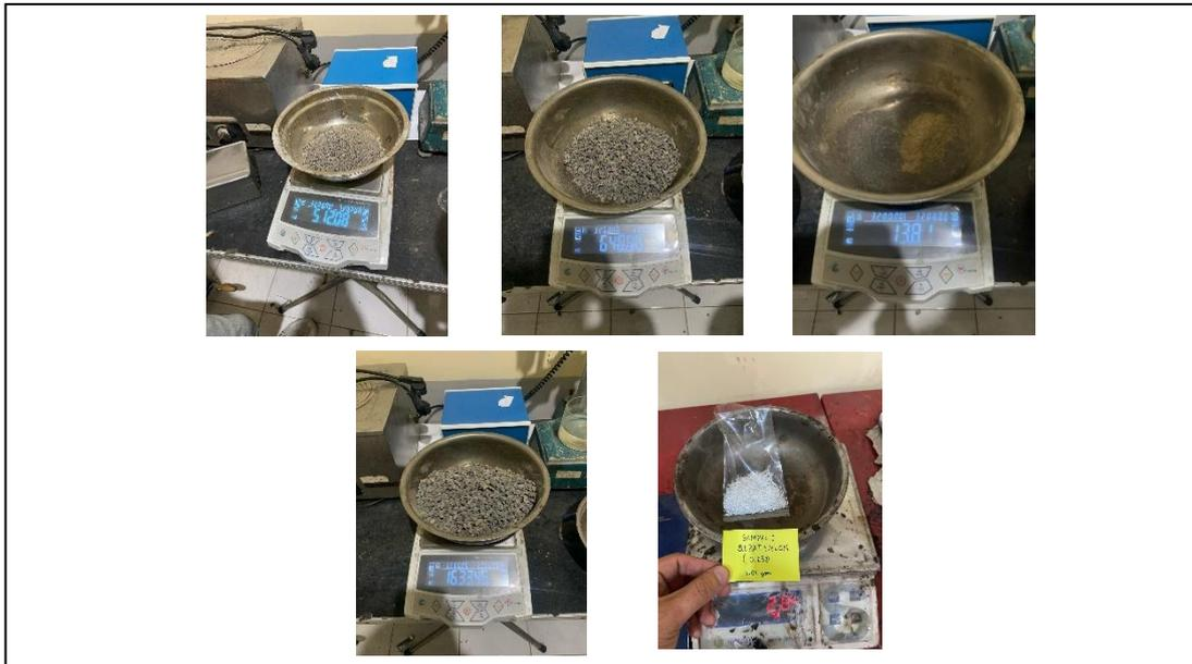
**Gambar 4.28** Penimbangan agregat dan serat dengan timbangan digital
