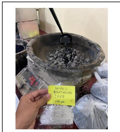
**Gambar 4.30** Proses pencampuran Aspal di wadah tahan panas
