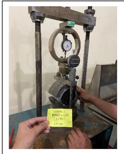
**Gambar 4.38** Proses pengujian di mesin Marshall
