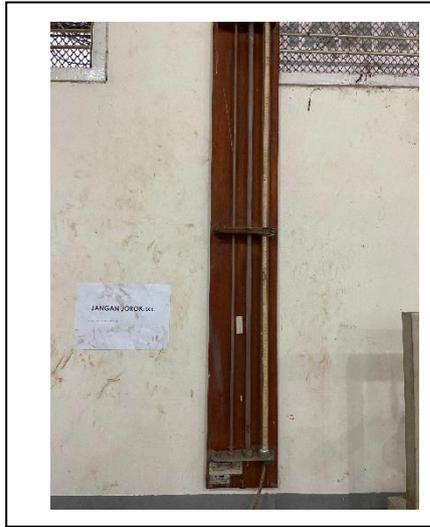
**Gambar 4.43** Pengukuran head air menggunakan mistar
