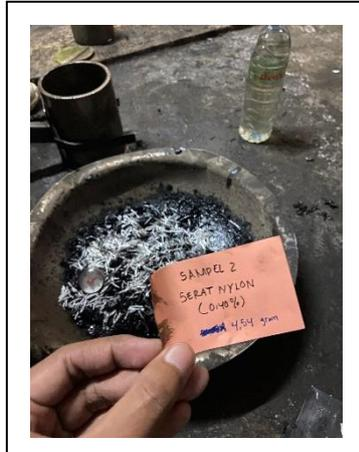
**Gambar 4.32** proses pemindahan campuran ke cetakan.
