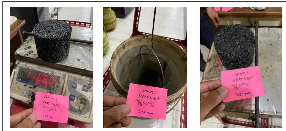
**Gambar 4.36** Proses penimbangan kering, SSD, dan dalam air
