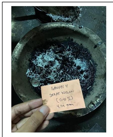
**Gambar 4.31** proses pencampuran Aspal dengan serat tali
