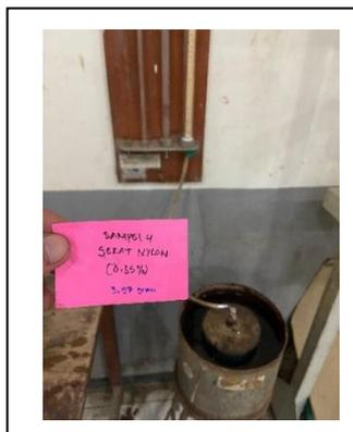
**Gambar 4.44** Air mengalir dan ditampung di bawah alat uji
