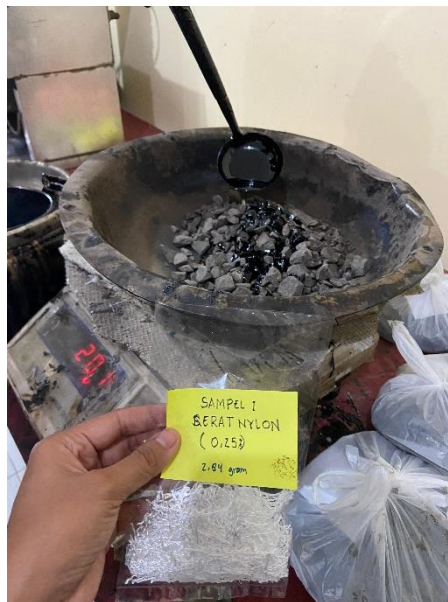
Gambar 21: Proses pencampuran Aspal di wadah tahan panas
