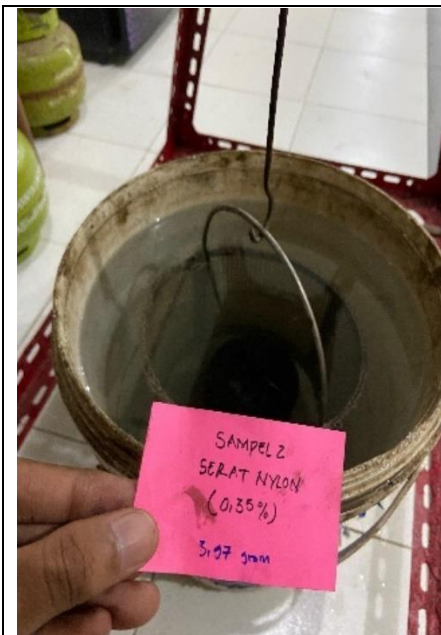
Gambar 30 : : Penimbangan sampel dalam keadaan didalam air
