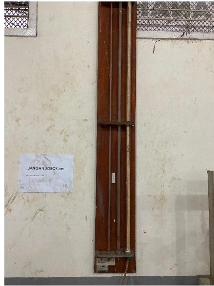
Gambar 35 : Alat uji permeabilitas
