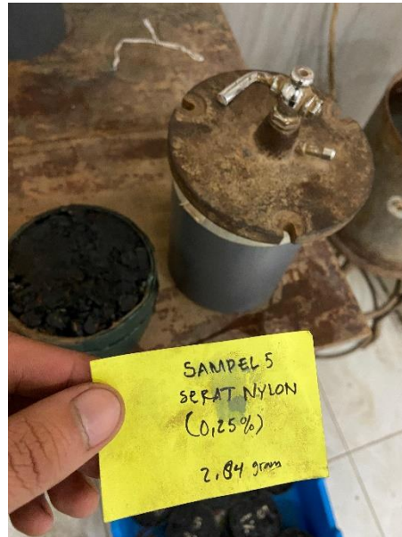
Gambar 37 : Pemasangan sampel permeabilitas
