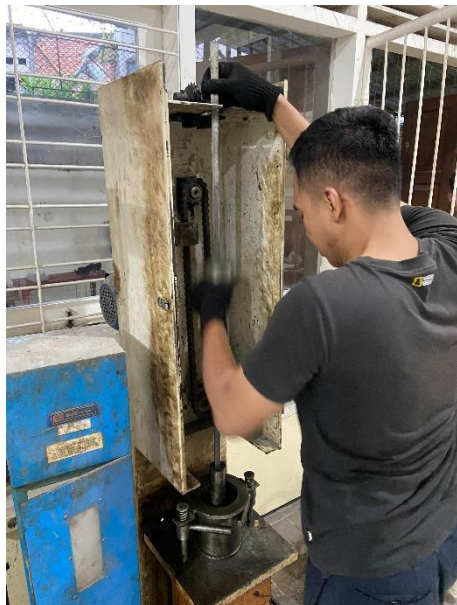
Gambar 24 : Pemadatan menggunakan compactor masrshall
