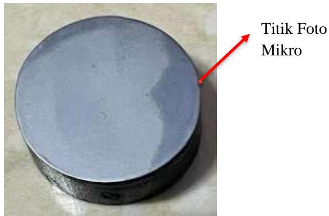
Gambar 4. 1 Lokasi pengambilan struktur mikro spesimen (Sumber : Dokumen Pribadi)
