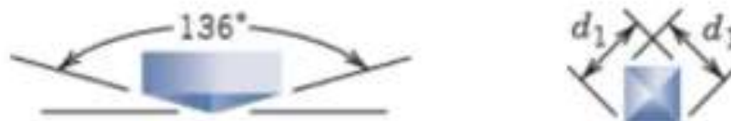
Gambar 2. 20 Bentuk indenter dan hasil indentasi Vickers ..
