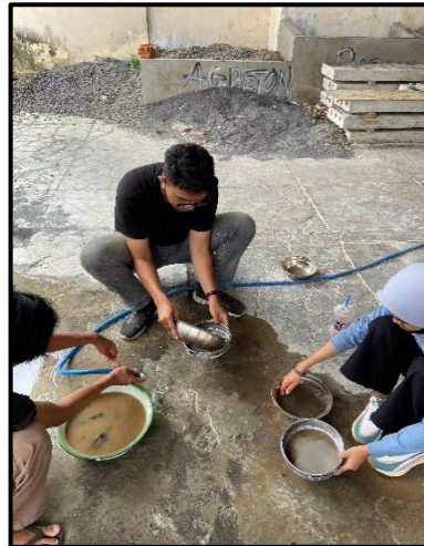
Gambar 4.7 Dokumentasi pengujian lolos ayakan No.200
