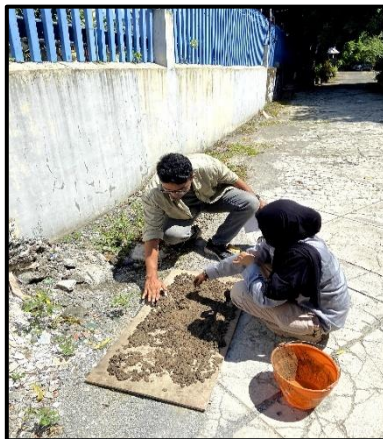
Gambar 4.5 Dokumentasi pengujian berat jenis kondisi SSD
