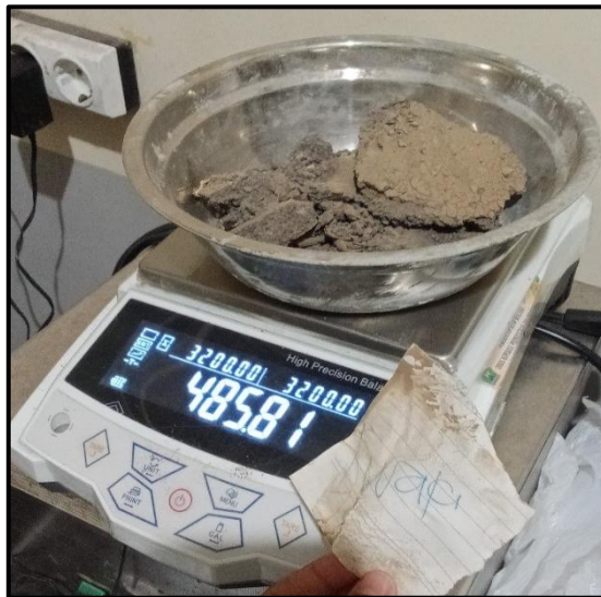
Gambar 4.8 Dokumentasi pengujian gumpalan lempung setelah di oven
