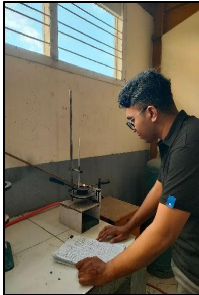
Gambar 4.11 Dokumentasi pengujian titik nyala dan titik bakar
