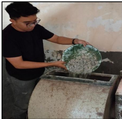
Gambar 4.6 Dokumentasi pengujian abrasi
