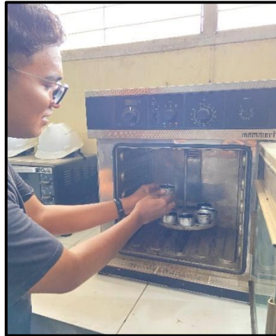
Gambar 4.15 Dokumentasi pengujian kehilangan berat minyak aspal
