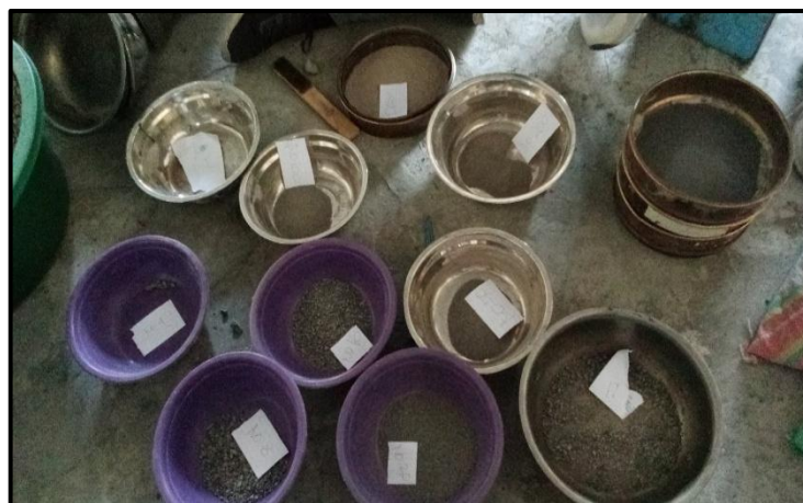
Gambar 4.4 Dokumentasi pengujian analisa saringan agregat yang tertahan di setiap saringan
