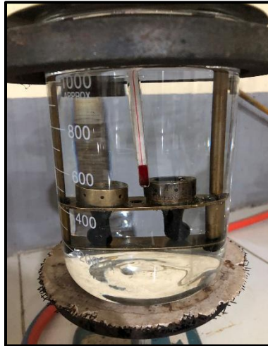
Gambar 4.12 Dokumentasi pengujian titik lembek
