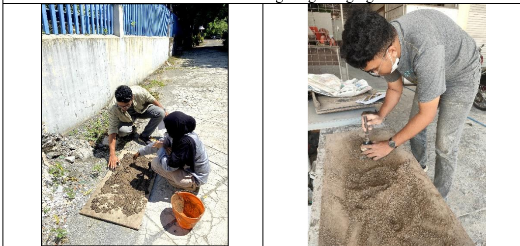
Gambar 3 Persiapan Pengujian Berat Jenis SSD
