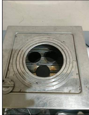
Gambar 12 Pengujian Kehilangan Berat (TFOT)
