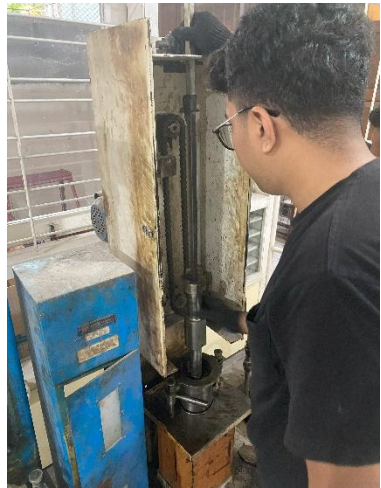
Gambar 19 Pemadatan Benda Uji
