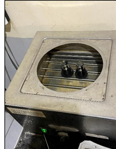
Gambar 13 Pengujian Berat Jenis Aspal
