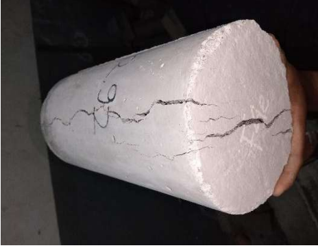
Gambar 4.62 Pola Retak Silinder F4e (Sumber: Hasil Penelitian)
