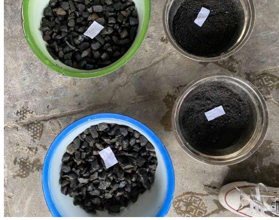
Gambar 4.7 Proses Pemeriksaan Kadar Air Agregat
