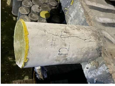
Gambar 4.43 Pola Retak Silinder F4b (Sumber: Hasil Penelitian)
