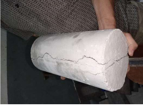
Gambar 4.63 Pola Retak Silinder F5d (Sumber: Hasil Penelitian)
