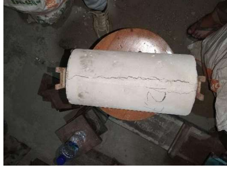
Gambar 4.61 Pola Retak Silinder F36 (Sumber: Hasil Penelitian)
