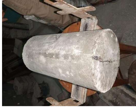
Gambar 4.60 Pola Retak Silinder F24 (Sumber: Hasil Penelitian)
