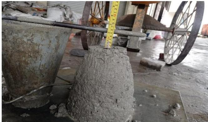
**Gambar 2.2** Pengukuran Nilai *Slump*
