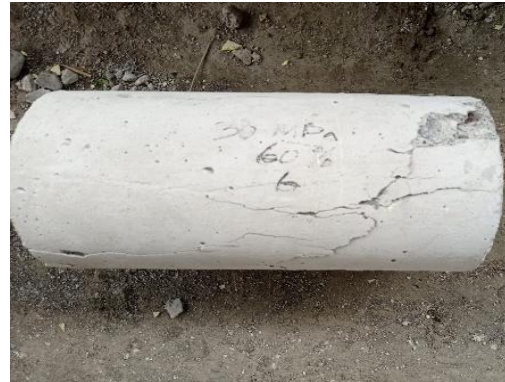
Gambar 4.28 Pola Retak Silinder J5.5
