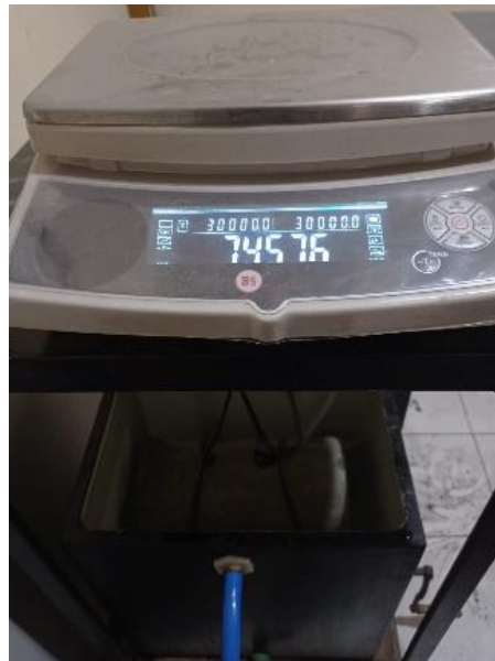
Gambar 4.36 Penimbangan sampel J5.1 di dalam air (Sumber: Dokumentasi Penelitian)
