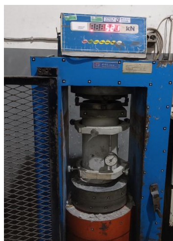
Gambar 4.21 Pengujian Kuat Tekan Silinder J1.4
