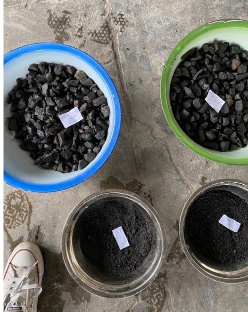
Gambar 4.7 Proses Persiapan Pengeringan Agregat
