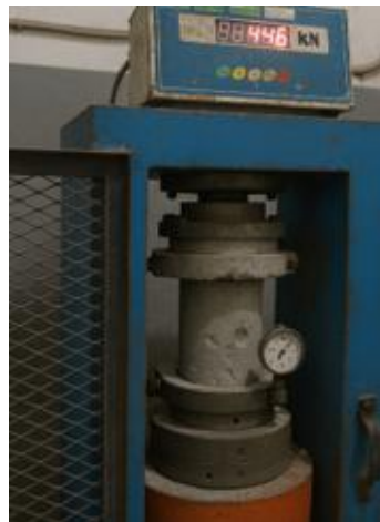
Gambar 4.22 Pengujian Kuat Tekan Silinder J1.5
