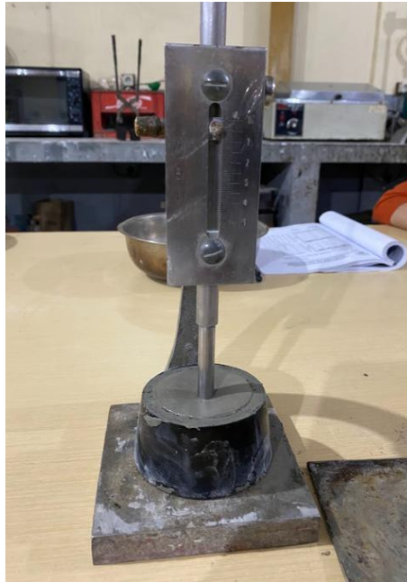
Gambar 4.9 Pengujian Konsistensi Normal Semen
