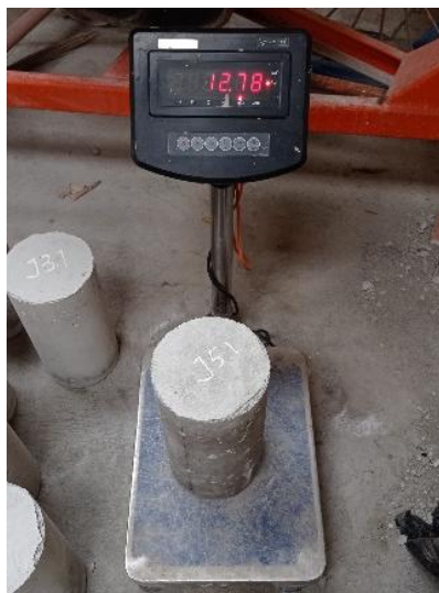
Gambar 4.34 Penimbangan sampel J5.1 saat kondisi kering
