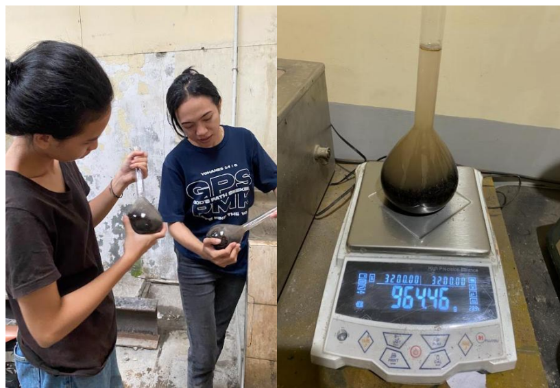
Gambar 4.8 Proses Pemeriksaan Berat Jenis Agregat
