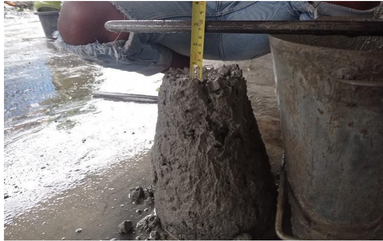
Gambar 4.17 Nilai slump 7,5 cm
