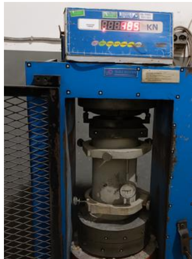
Gambar 4.24 Pengujian Kuat Tekan Silinder J2.3
