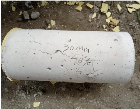
Gambar 4.27 Pola Retak Silinder J4.5
