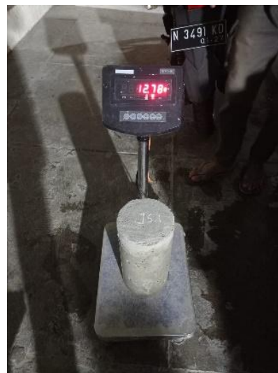
Gambar 4.35 Penimbangan sampel J5.1 saat kondisi jenuh
