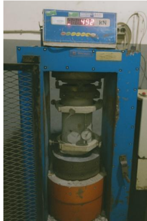
Gambar 4.25 Pengujian Kuat Tekan Silinder J2.6
