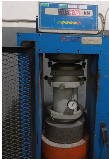
Gambar 4.23 Pengujian Kuat Tekan Silinder J1.6
