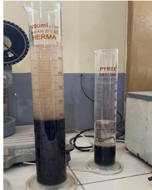
Proses Pemeriksaan Kadar Zat Organik dan Kadar Lumpur pada Agregat Halus
