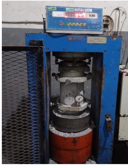
Pengujian Kuat Tekan Benda Uji Variasi 3% Kode J4.6
