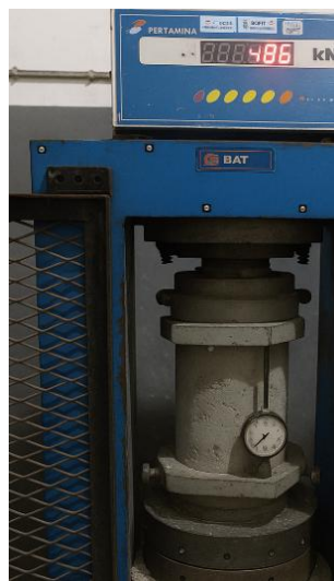
Pengujian Kuat Tekan Benda Uji Variasi 2% Kode J3.4
