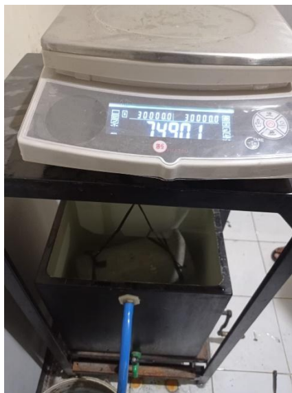
Penimbangan Benda Uji untuk mencari nilai M3 (dalam Uji Porositas)
