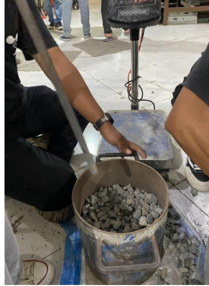
Proses pemadatan agregat untuk pemeriksaan berat isi
