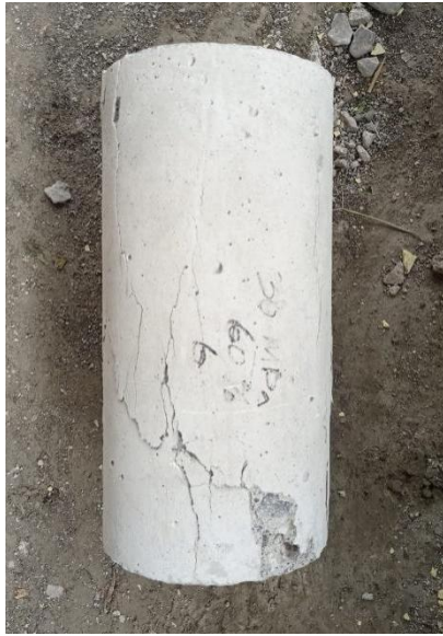
Pola retak silinder beton variasi 3%
