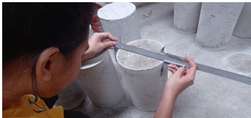
Pengukuran Dimensi Benda Uji dengan jangka sorong
