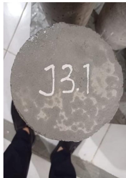
Benda Uji setelah ditimbang dalam air (dalam Uji Porositas)
