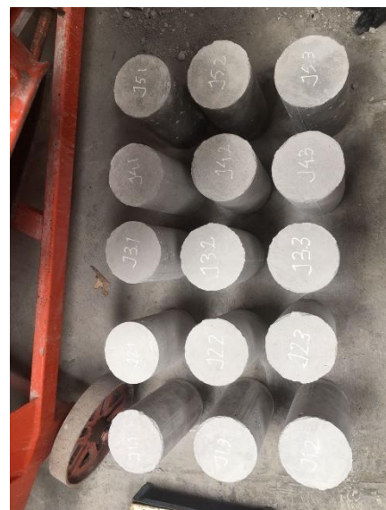
(Setelah curing beton)
