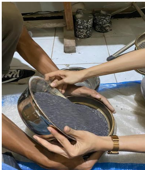
Proses pengayakan dalam pemeriksaan Analisis Saringan
