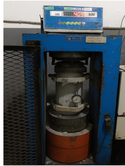
Pengujian Kuat Tekan Benda Uji Variasi 4% Kode J5.6
