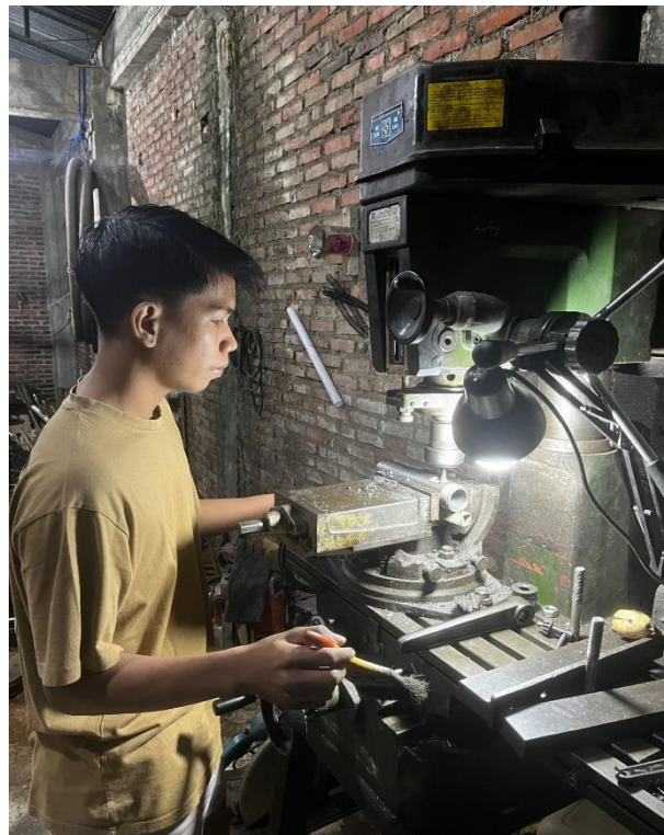
Gambar frais untuk lubang masuk biji plastik
