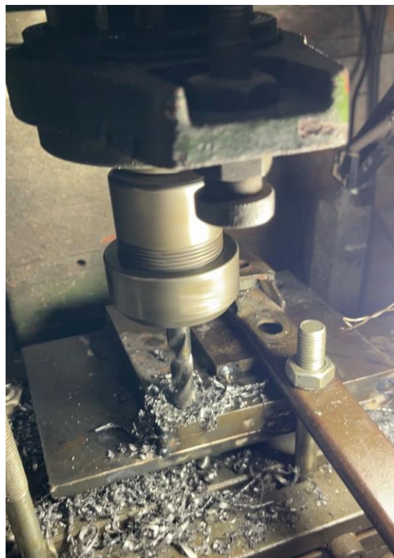
Gambar Proses pengeboran Plat kontruksi
