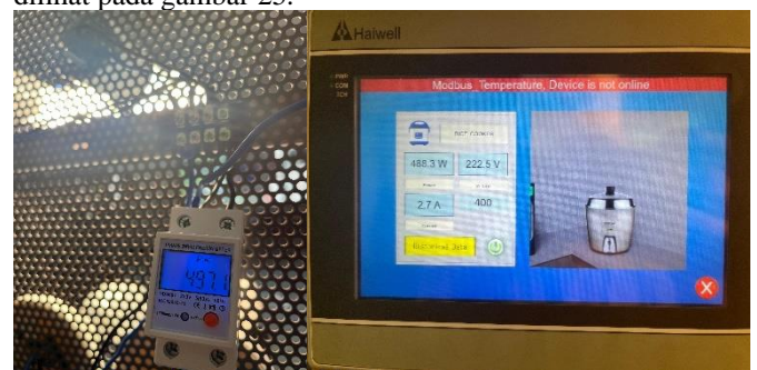
Gambar 28. Perbandingan Tampilan SCADA Dan kWh Meter Digital
