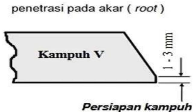
Gambar 3. 3 : Pembuatan Root Face Pada Kampuh
