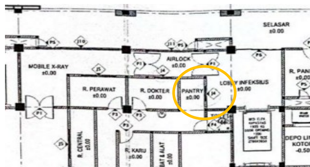
Gambar 4.43 Denah Rencana Jendela Tipe J4.
