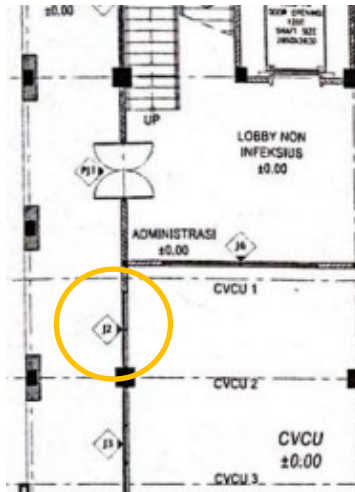
Gambar 4.41 Denah Rencana Jendela Tipe J2.
