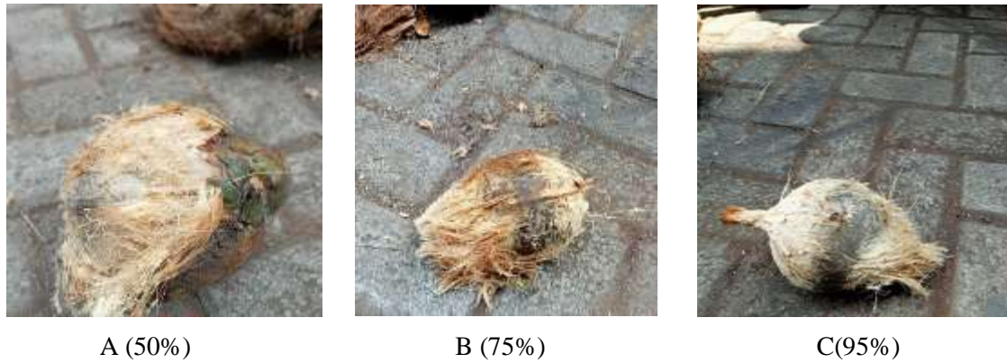
Gambar 4. 2 (A).Hasil Pengujian Rpm 685.(B).Hasil Pengujian RPM 785.(C).Hasil Pengujian RPM 885 Sumber : Rainerius T. Rabin,2024
