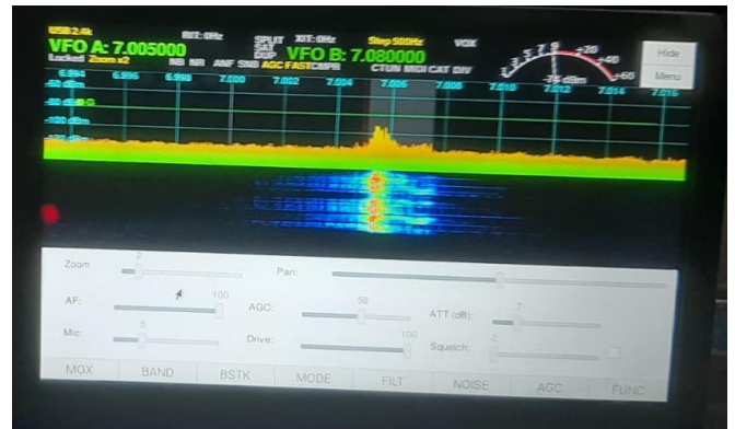
Gambar 4. 6 Pengujian Kualitas Modulasi USB
