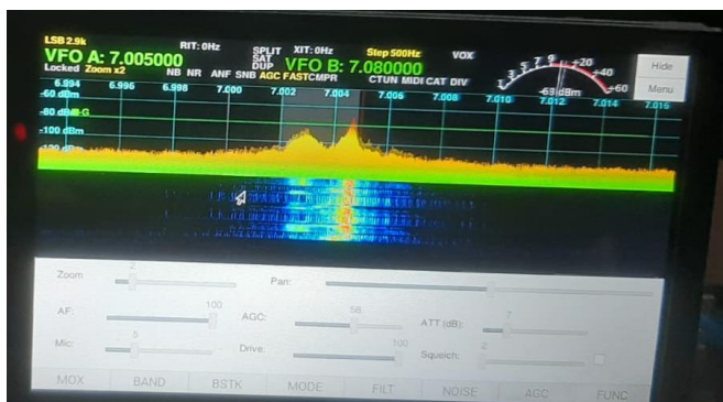
Gambar 4. 5 Pengujian Kualitas Modulasi LSB
