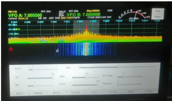
Gambar 4. 3 Pengujian Kualitas Modulasi AM
