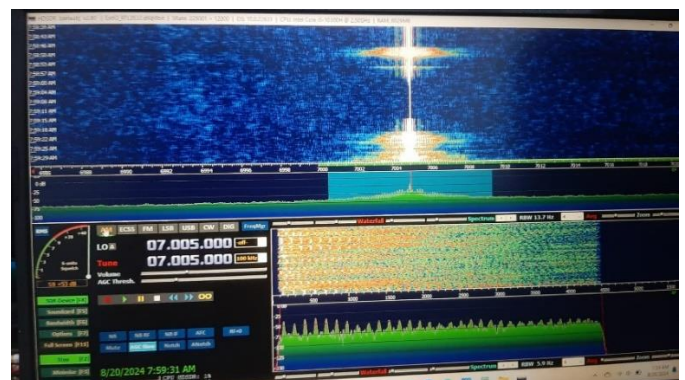
Gambar 4. 7 Pengujian Kualitas Demodulasi AM
