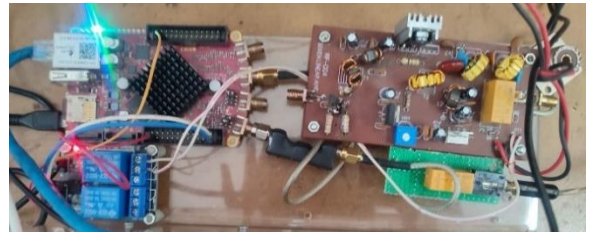
Gambar 18. Menghubungkan Red Pitaya ke RF Power Amplifier
