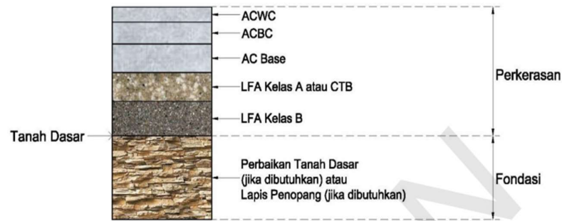
Gambar 2. 2 Struktur Perkerasan Lentur Sumber: Direktorat Jendral Bina Marga,2017
