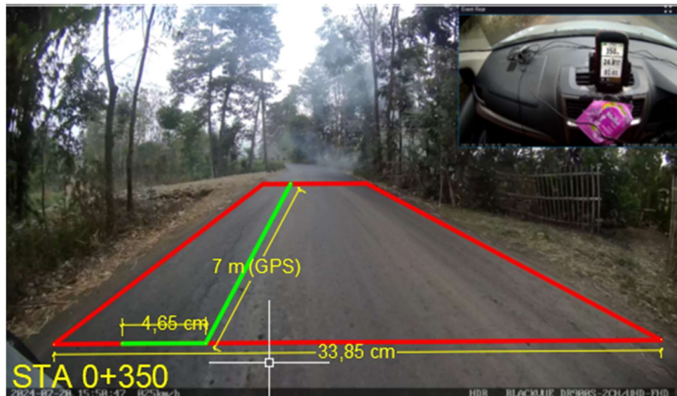
Gambar 4. 22 Pengukuran Skala Dimensi Panjang Lebar Sumber : Analisa Kerusakan Menggunakan AutoCAD
