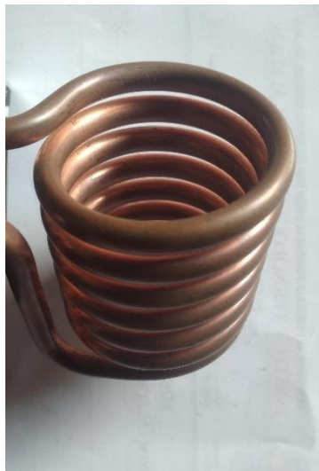
Gambar 3. 12 Kumparan Kerja (Sumber : Iqbal, 2024)
