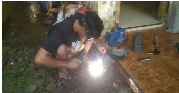
Gambar 3.41 Proses Pengelasan kaki - kaki Ruang Bakar Kompor
