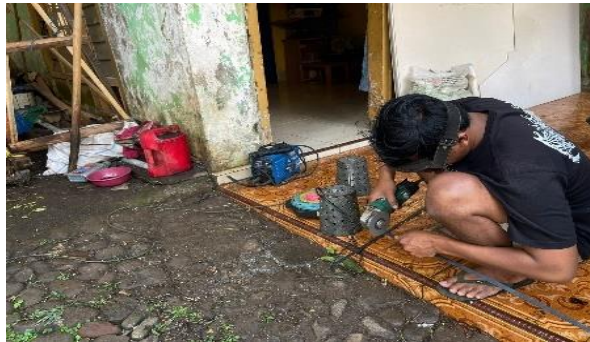
Gambar 3.40 Proses Pemotongan kaki - kaki Ruang Bakar Kompor
