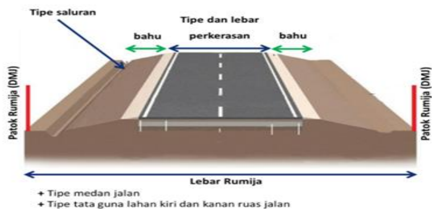
Gambar 2. 18 Data Invetarisasi Jalan (Sumber : Modul 2 Survei Pengumpulan Data PKRMS, 2022, hal 41)
