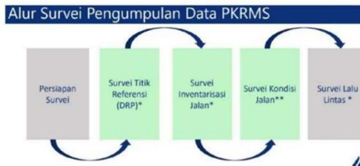
**Gambar 2.14** Alur Tahapan Survei Pengumpulan Data Dengan PKRMS
