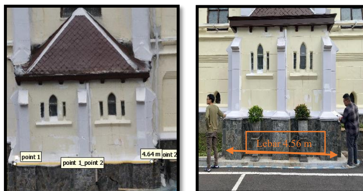
Gambar 4. 24 Jarak pada Orthophoto dan Jarak Dilapangan
