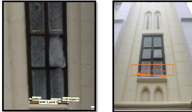
Gambar 4. 25 Jarak pada Orthophoto dan Jarak Dilapangan
