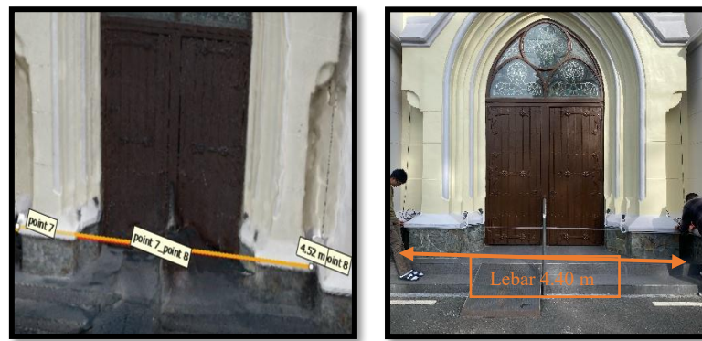
Gambar 4. 23 Jarak pada Orthophoto dan Jarak Dilapangan
