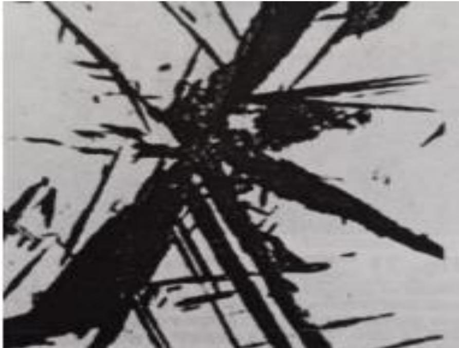
Gambar 2. 10 Struktur mikro bainit perbesaran perbesaran 500x
