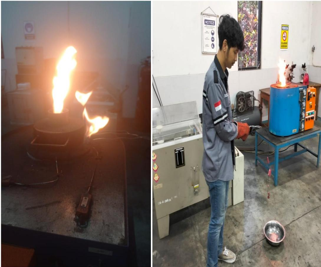
Gambar Saat Proses *Carburizing* dan *Quenching* Menggunakan Air
