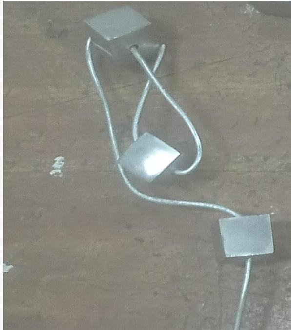
Gambar 3. 12 Spesimen *vickers* sebelum *carburizing*
