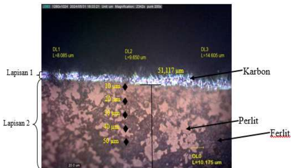
Gambar 2. Ketebalan lapisan baja AISI 1050 hasil proses karburisasi dengan menggunakan laju aliran gas 20 cm 3 /min
