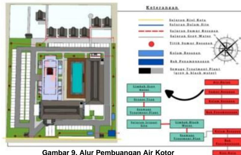
Gambar 9. Alur Pembuangan Air Kotor
