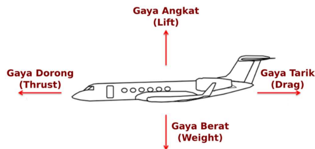
Gambar 2.1 Mekanisme Pesawat Terbang
