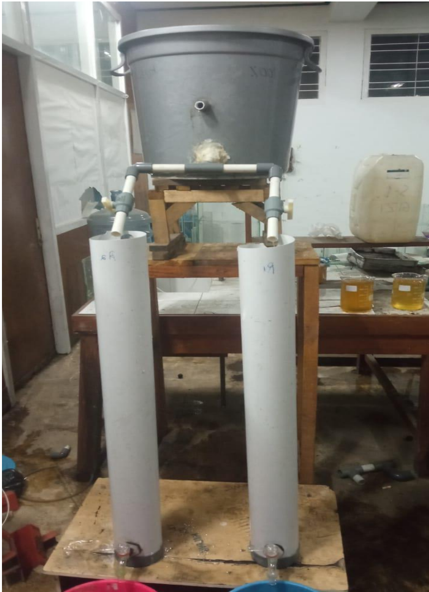
Gambar 4 Gambar reaktor filtrasi
