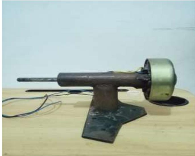
Gambar 1. Hasil Pembuatan Generator
