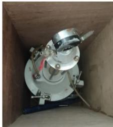
Gambar 3.1 Alat Uji Kadar Udara Beton Segar
