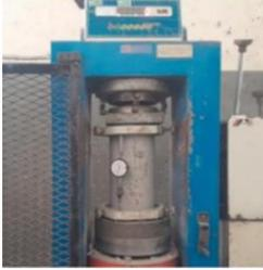
Gambar 3.7 Alat Uji Modulus Elastisitas
