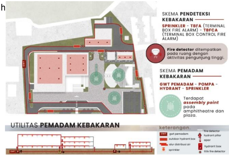
Gambar 12. Utilitas Pemadam Kebakaran Sumber : Analisa Pribadi, 2025
