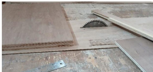
Gambar 1. 3 Mesin Pemotong Tanpa Pelindung
