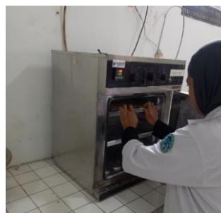
Proses pengeringan biji kelor menggunakan oven
