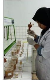
Proses mengambil sampel uji setelah pengendapan yang akan di analisis Kandungan Bakteri E-Coli dan Total Coliform
