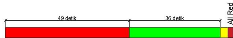
Gambar 4. 4 Fase dan Diagram waktu siklus simpang Soekarno Hatta
