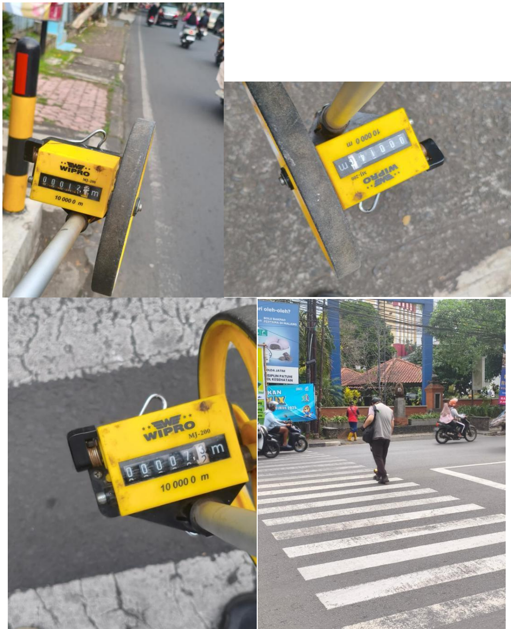
Gambar Pengukuran Lebar Jalan menggunakan WIPRO Metering Wheel
