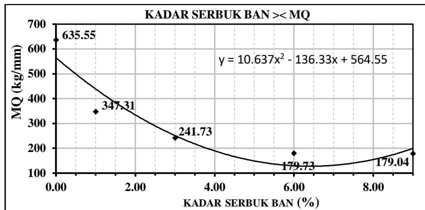
Gambar 4. 28 Grafik pengaruh penambahan kadar serbuk ban terhadap MQ
