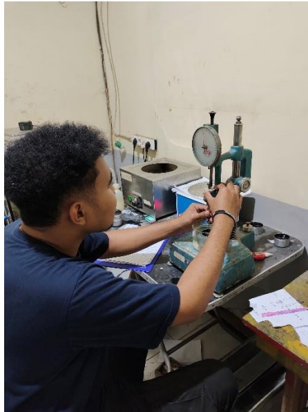
Gambar 4. 9 Proses Pengujian Penetrasi Aspal
