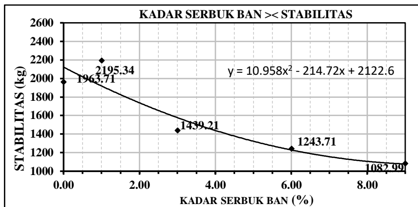
Gambar 4. 23 Grafik pengaruh penambahan kadar serbuk ban terhadap stabilitas
