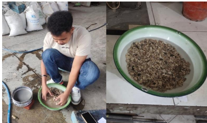
Gambar 4. 8 Proses Pemeriksaan Material Lolos Ayakan No.200
