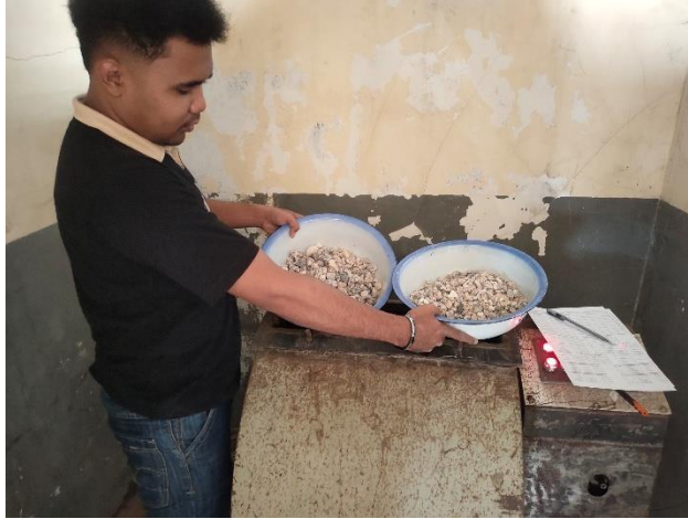
Gambar 4. 7 Proses Pemeriksaan Keausan Agregat
