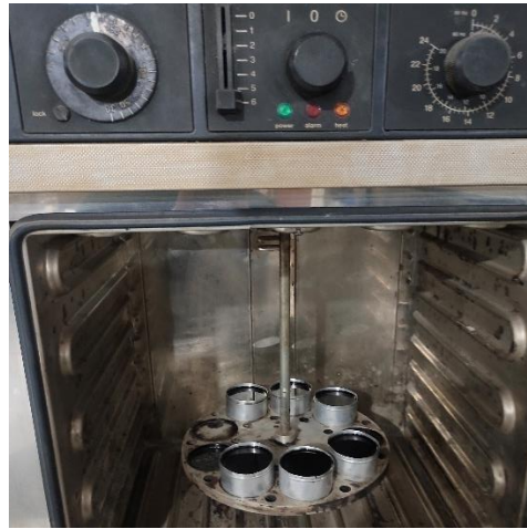
Gambar 4. 12 Proses Pengujian Kehilangan Berat Minyak dan Aspal
