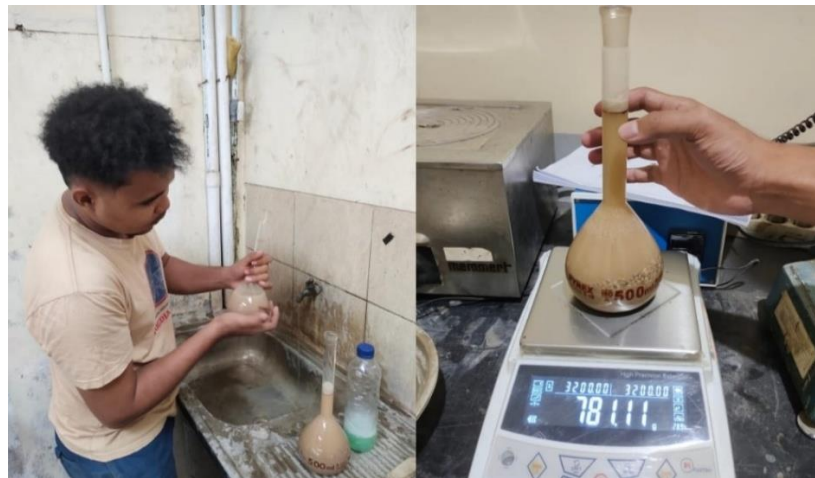
Gambar 4. 6 Proses Pemeriksaan Berat Jenis Agregat
