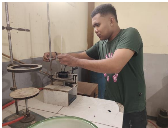
Gambar 4. 10 Proses Pengujian Titik Nyala dan Titik Bakar Aspal
