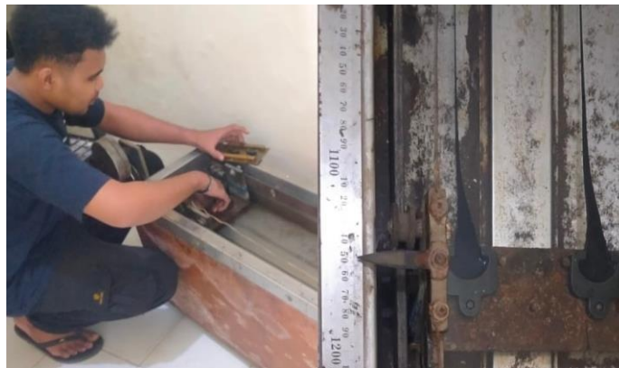
Gambar 4. 11 Proses Pengujian Daktilitas Aspal
