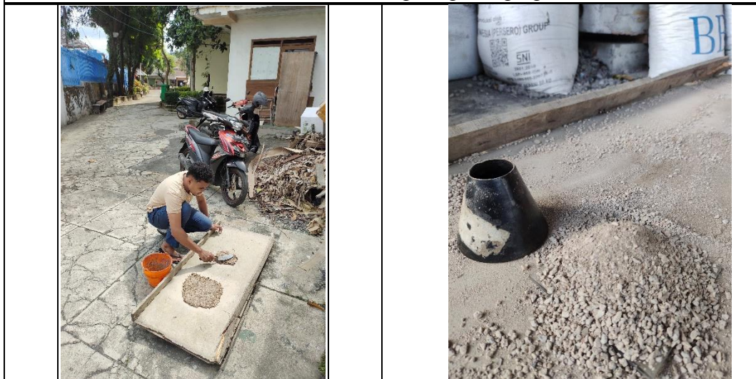
Gambar 3 Persiapan Pengujian Berat Jenis SSD
