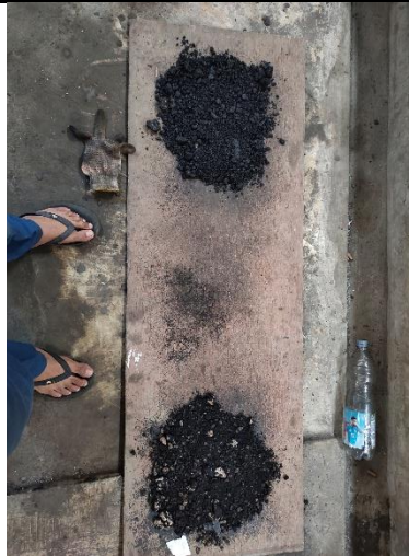
Gambar 15 Trial untuk Menentukan Kadar Aspal Tengah
