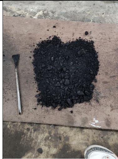
Gambar 15 Trial untuk Menentukan Kadar Aspal Tengah
