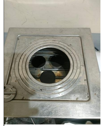
Gambar 12 Pengujian Kehilangan Berat (TFOT)
