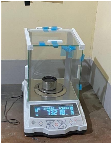
Gambar 12 Pengujian Kehilangan Berat (TFOT)
