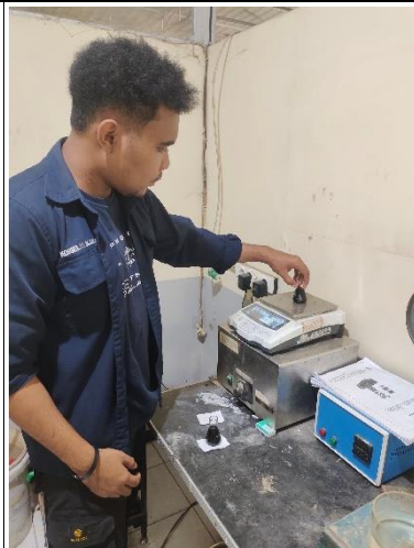
Gambar 13 Pengujian Berat Jenis Aspal
