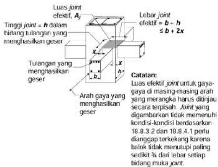
Gambar 2.29 Luas Hubungan Balok Kolom (Joint) Efektif
