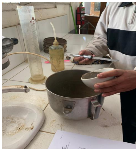
Gambar 4.3 Pengujian Analisa Hidrometer
