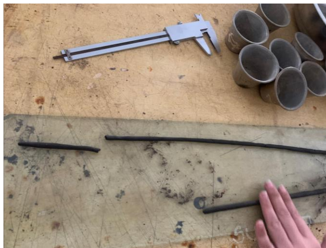
Gambar 4.7 Pengujian Batas Plastis Tanah
