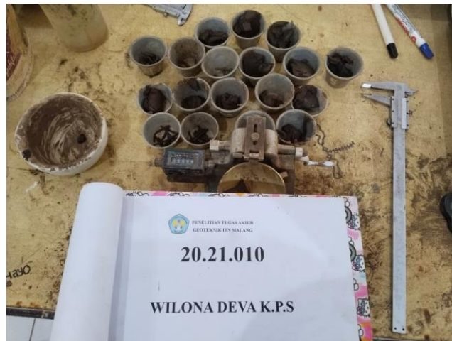
Gambar 4.6 Pengujian Batas Cair Tanah
