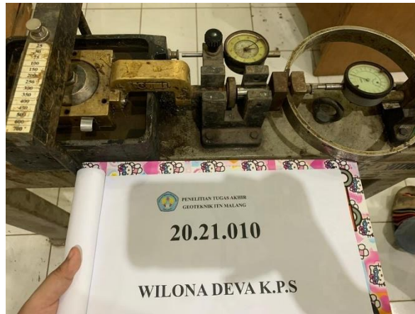
Gambar 4.9 Pengujian Direct Shear
