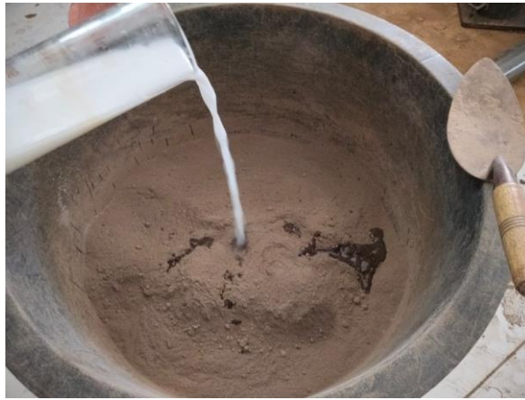
Lampiran 6. Pencampuran Tanah, Abu, dan Larutan Bakteri
