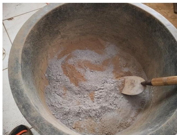
Lampiran 5. Pencampuran Tanah dan Abu
