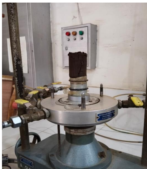
Lampiran 10. Pengujian Triaxial
