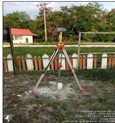
Gambar 2. 6 Pengamatan statik GPS(sumber:dokumentasi Pribadi 2025)
