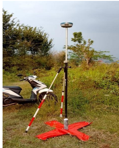
Gambar 3. 4 Proses Pengamatan GNSS
