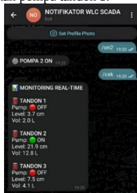
Gambar 23. Kontrol Status Pompa /on 2 Telegram
