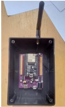
Gambar 12. Perangkat Keras Sistem Notifikasi
