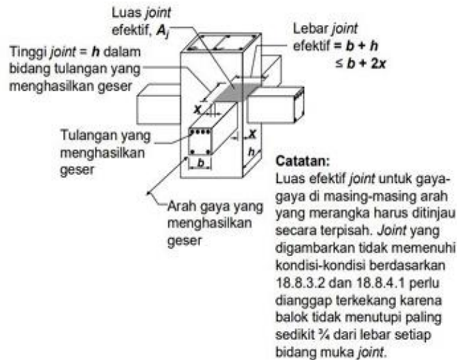
Gambar 4. 30 Luas Hubungan Balok Kolom (Joint) Efektif
