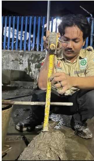
Gambar 4. 34 Slump Test Variasi 0,3% Sumber: (Hasil Penelitian)
