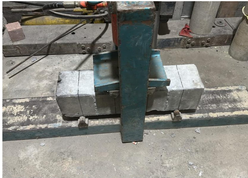
Gambar 4. 39 Uji Kuat tarik lentur beton variasi 0,1% sampel 1
