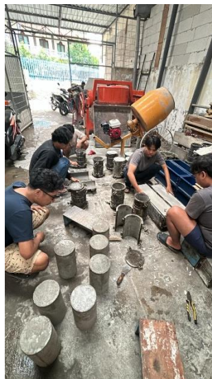
Gambar 4. 28 Pembukaan Benda Uji Dari Bekisting Sumber: (Dokumentasi Pribadi)
