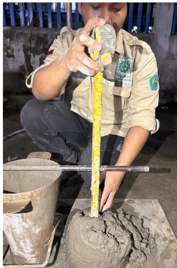
Gambar 4. 33 Slump Test Variasi 0,2% Sumber: ( Hasil Penelitian )
