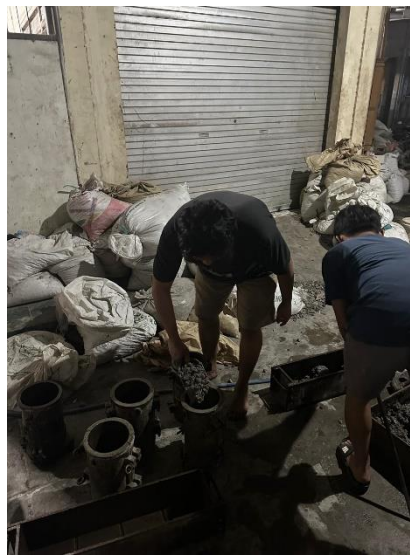
Gambar 4. 27 Pengecoran dan Pemadatan Benda Uji Sumber:(Dokumentasi Pribadi)
