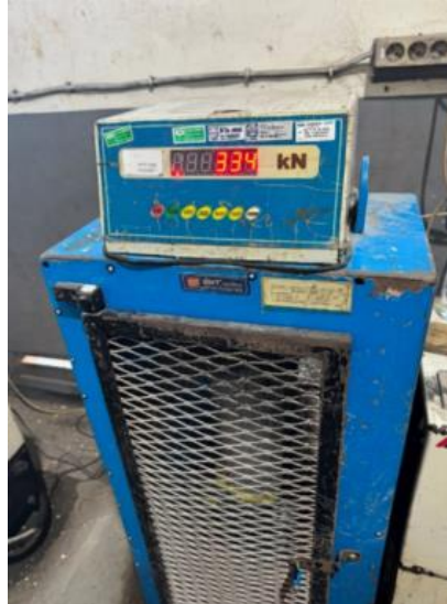
Gambar 4. 35 Uji Kuat Tekan Beton Variasi 0,1% Sampel 1
