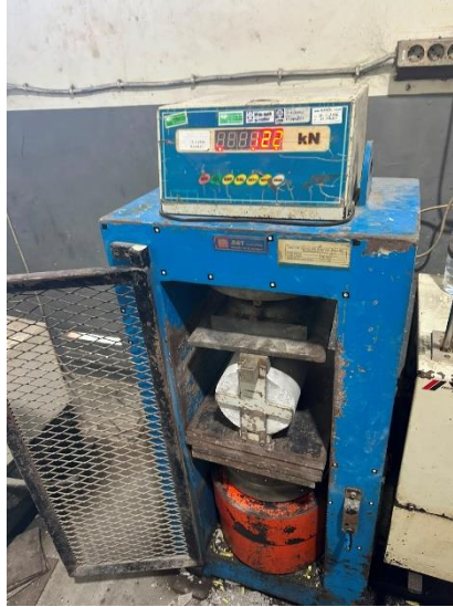
Gambar 4. 37 Uji Kuat tarik belah beton variasi 0,1% sampel 1
