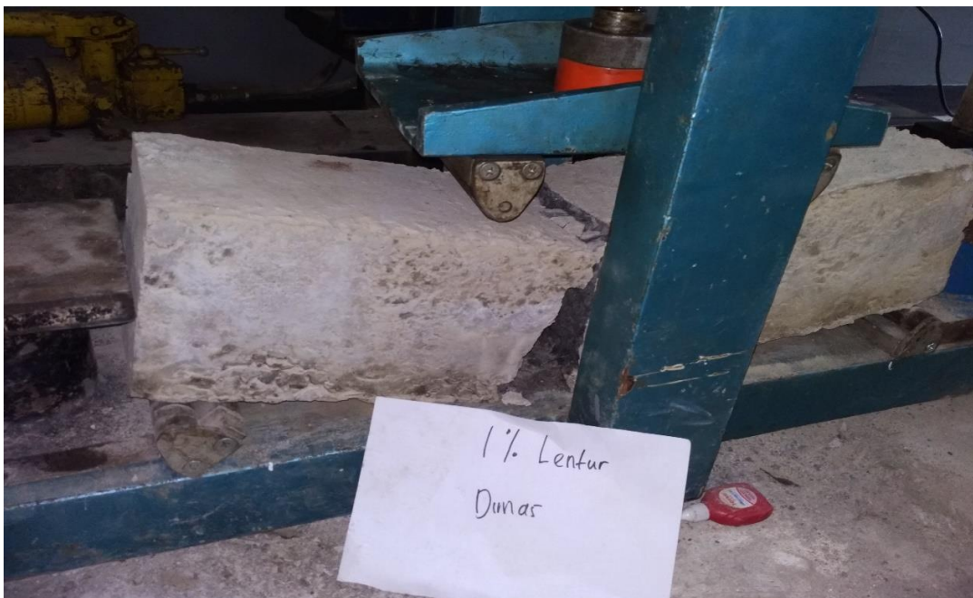
Beton setelah dilakukan pengujian kuat lentur menunjukan patah di tengah
