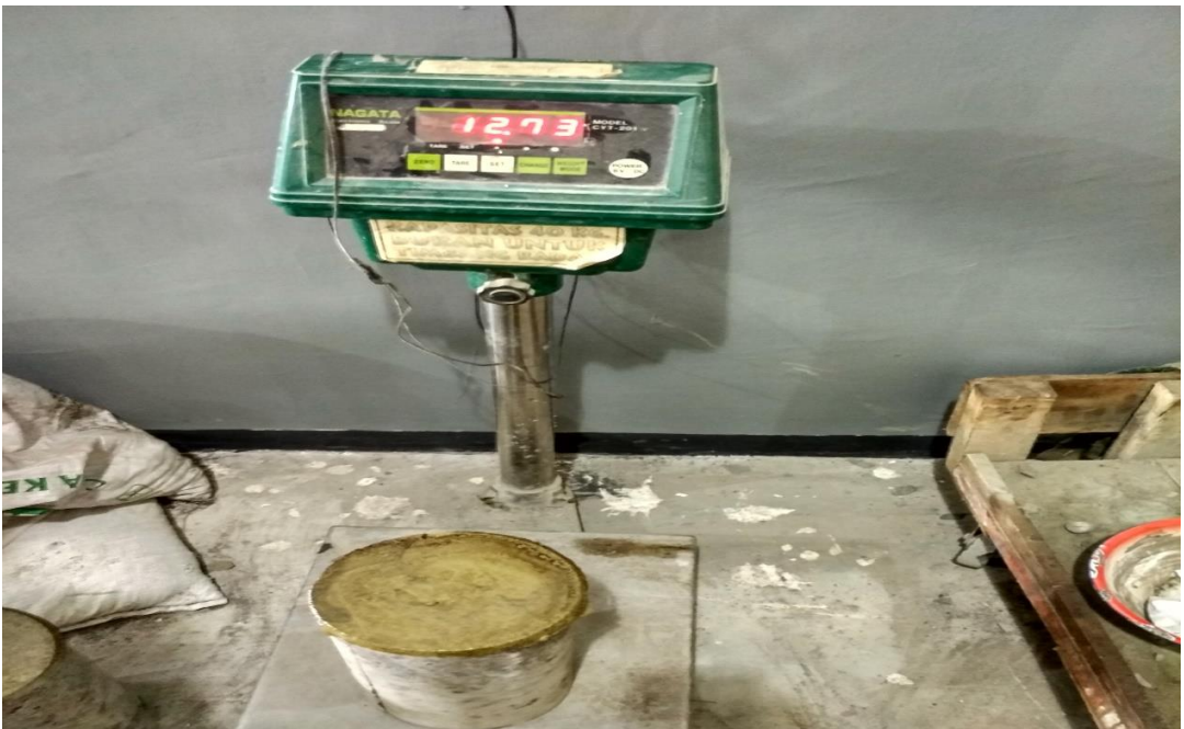
Proses menimbang benda uji silinder sebelum dilakukan pengujian
