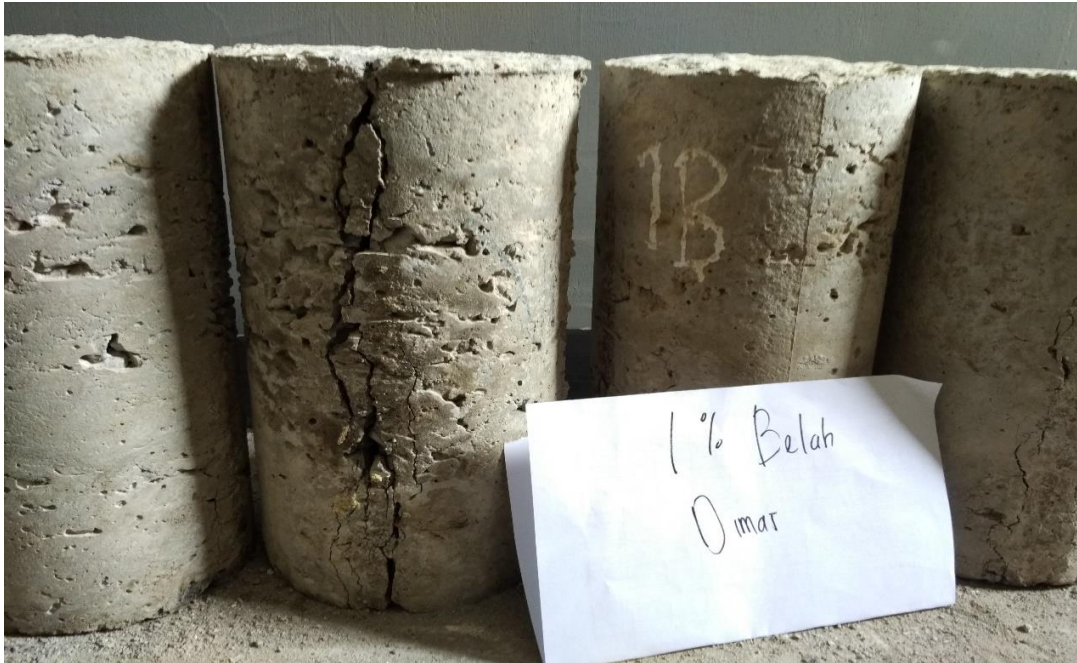
Beton setelah dilakukan pengujian kuat tarik belah
