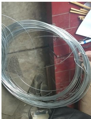
Gambar 4.6 kawat diameter 1,6 mm
