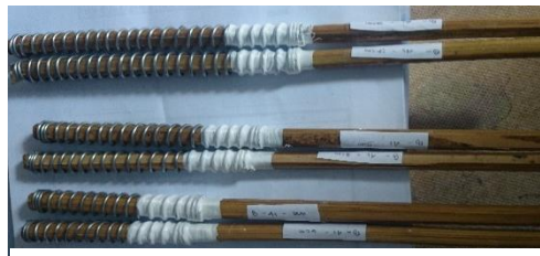
Tulangan Bambu uji panjang penyaluran dengan kawat \emptyset 1,6 mm
