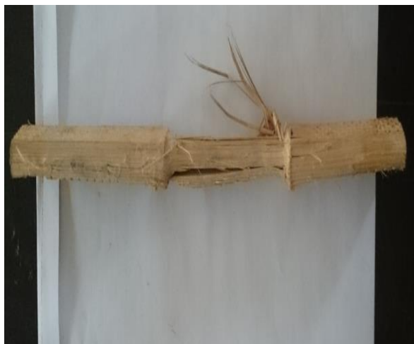
Gambar 4.4 Hasil Bambu Setelah pengujian Tarik
