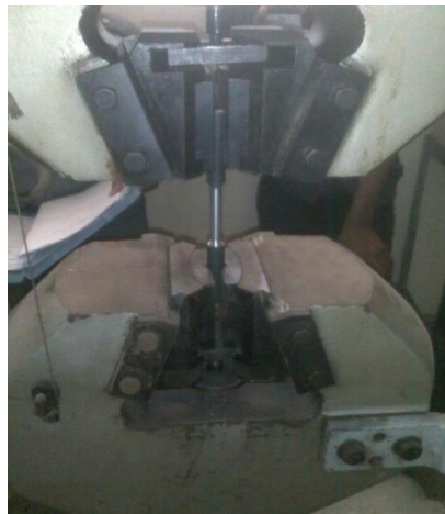
Gambar 4.1 Pengujian Tarik Tulangan Baja
