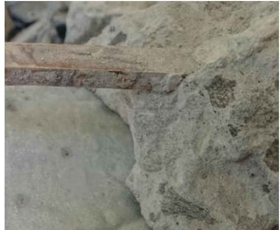
Gambar 5.5. Bambu (BL) setelah beton mengering
