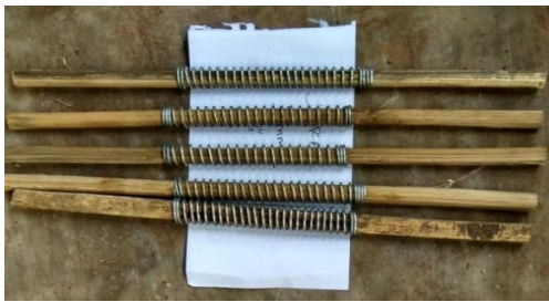
Tulangan Bambu uji lekatan dengan kawat \emptyset 1,6 mm
