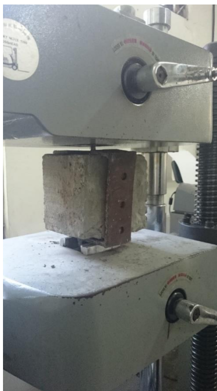
Gambar 3.5 Alat uji kekuatan lekatan dan panjang penyaluran menggunakan alat uji tarik Universal Testing Machine
