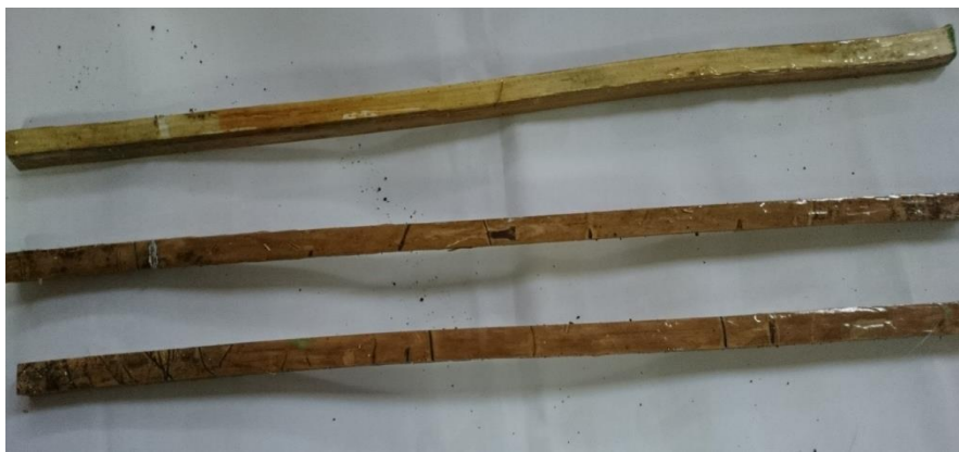
Gambar 4.7 Pelapisan Tulangan Bambu Menggunakan Lem
