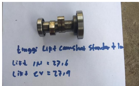
Gambar 3.13 camshaft standar penambahan tinggi lift 1mm (sumber gambar pribadi)
