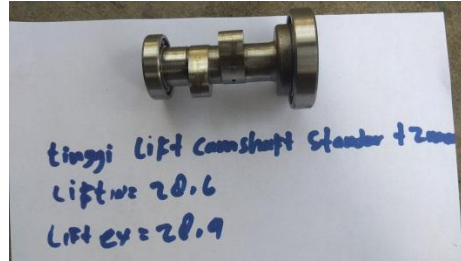
Gambar 3.15 gambar camshaft standar penambahan tinggi lift 2mm (sumber gambar pribadi)
