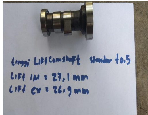
Gambar 3.12 camshaft standar penambahan tinggi lift 0,5mm (sumber gambar pribadi)
