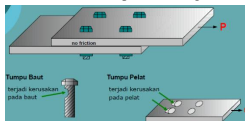
Gambar 2.18 Kegagalan tumpu baut ada ulir
